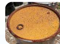
口栓及び天板の錆
